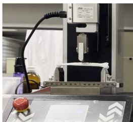
軸方向荷重試験および 3 点曲げ試験を実施する。
