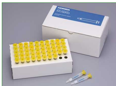
開発例2：カビ毒を濃縮精製 するためのアフィニティーカラム（製品化）
